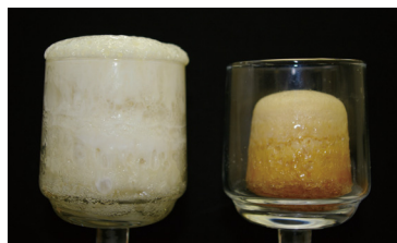
親水性の樹脂は水と混ざり合うことによりゲル化し乾燥環境で放置すると収縮します
