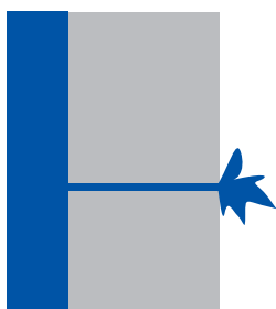
漏水が非常に激しい場合は前処理として導水をします
