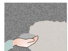
塗布した KD1 に擦り込み硬化させます 図4
