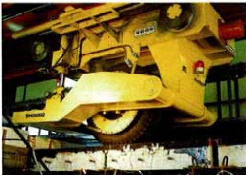
自走式輪荷重移動載荷試験
