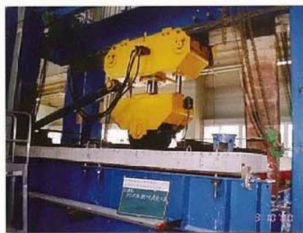
旧建設省土木研究所における輪荷重走行試験
