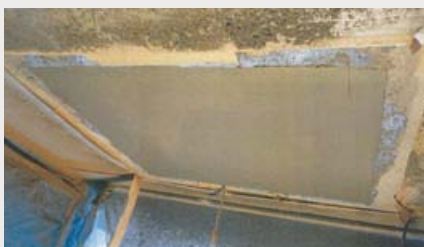
振動試験体（振動負荷終了時）
